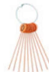
Bund Zähladeln aus orange beschichtetem Eisendraht, 4,5mm dick, 40cm lang. 0 - 9 (10 Nadeln) an 1 Tragring
